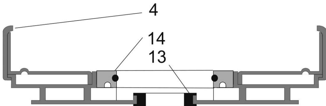
Díly 13 a 14 jsou vyjmateLNé a lze je samostatně vyměnit
