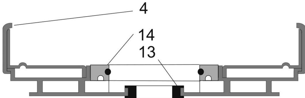
Díly 13 a 14 jsou vyjímatelné a lze je samostatně vyměnit
