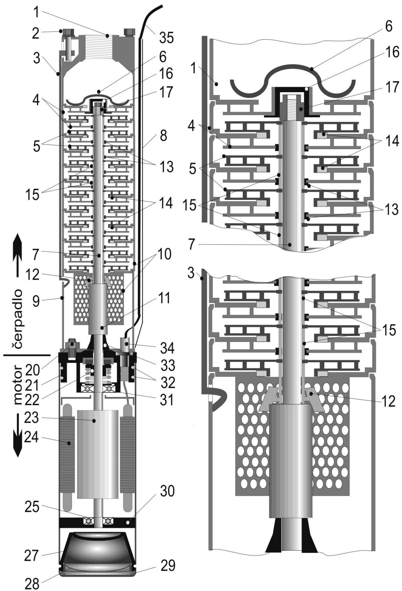
**Detail statorového článku s difuzorem kompletního:**
