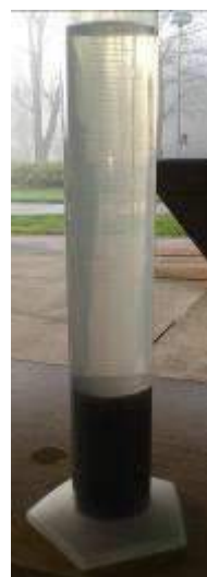
Odměrný válec po 30 min. sedimentace. Zřetelné rozhraní kalu a vody (zde např. nízká koncentrace kalu)
