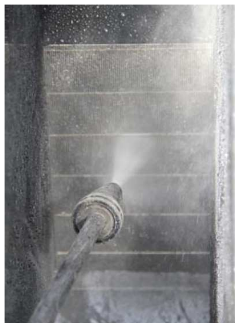
Obr. 29: Čištění síta pomocí vysokotlakého čističe
