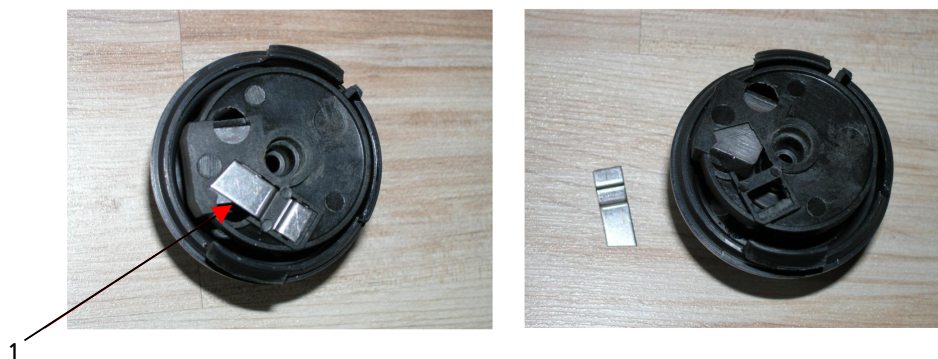
Obr. 8: Odstranění plechových proužků
