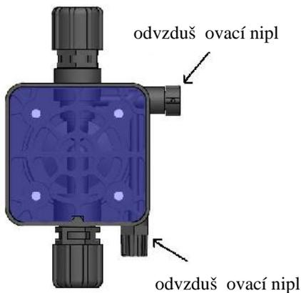
**I** -Svitare di mezzo giro la manopola di spurgo (in alto a destra del corpo pompa)
